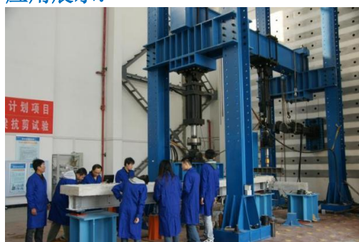
纤维增强材料-混凝土组合梁试验
