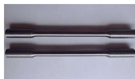
柱状拉伸试样（拉伸前）
