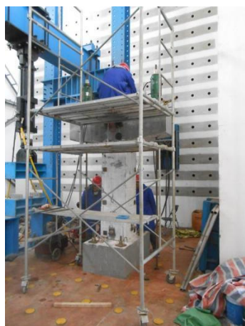
节段拼装 UHPC 空心墩拟静力试验
