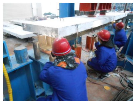
钢-UHPC 组合结构梁试验
