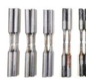
柱状拉伸试样（拉伸后）
