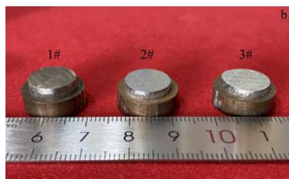
ECAP 挤压结合退火后铜铝双金属复合试样剪切试验
