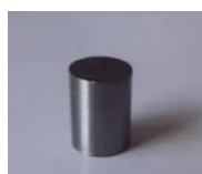
柱形压缩试样 (压缩前)
