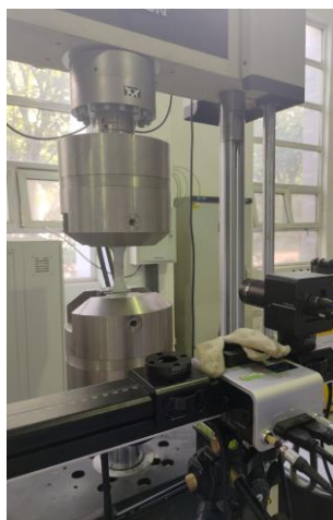
锈蚀钢材疲劳性能试验
