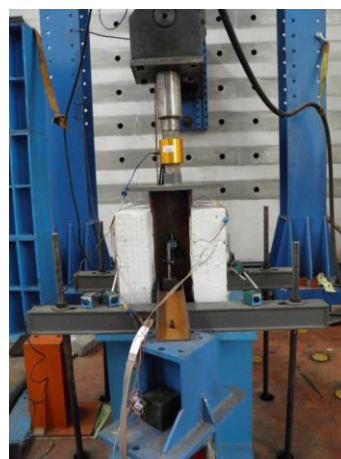
钢-UHPC 组合结构剪切试验
