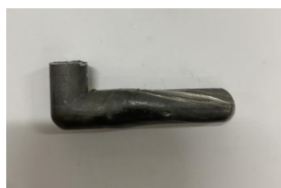
时效硬化型铝合金大塑性变形挤压
