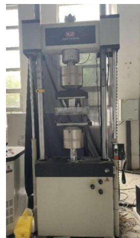
锈蚀 RC 梁受弯疲劳试验
