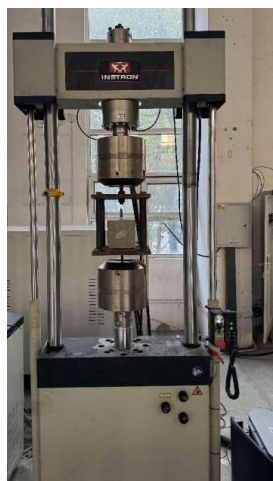
TRC 约束钢筋混凝土疲劳粘结试验
